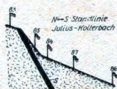
Abb. 3. Aus dieser Darstellung ist zu erkennen, daß die Änderungen der Ersatzkapazität bei Veränderung der Antennenhöhe ungleichmäßige sind in der Nähe einer Verwerfungsspalte (S). Aus entsprechenden Messungen lassen sich also Rückschlüsse auf die tektonischen Verhältnisse des Untergrundes ziehen.
