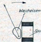
Weicheisensystem (für Gleich- und Wechselstrom, aber mit verschiedener Scala).
